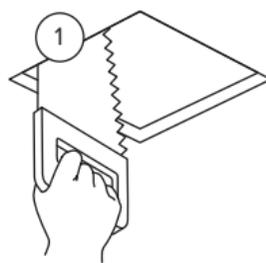
Вырезать в потолке установочные отверстия для светильников размером 86 на 86 мм.
