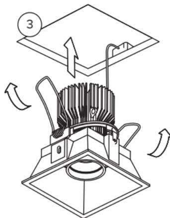
Установить светильник в отверстие, с помощью клипс зафиксируйте светильник в потолке
